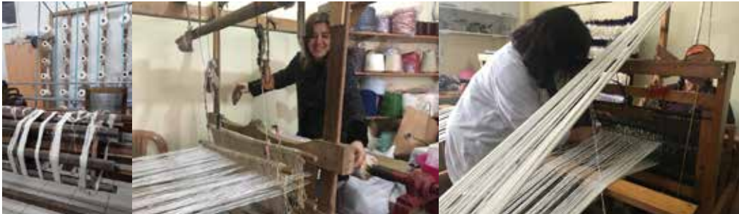
Fotoğraf 6. Çözgü Hazırlık İşlemi, Tezgâh ve Tahar İşlemi. Çaycuma- Zonguldak. (Şavkar, 2019)
