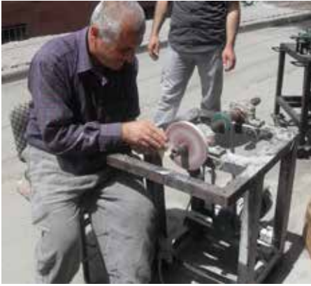
Fotoğraf 6. Cilâlama İşlemi ve Yapımı Tamamlanmış Tarak (Emine Tonus,2008).
