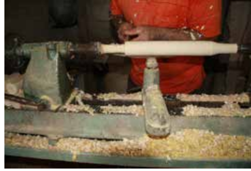
Fotoğraf 4. Merdane Yapım Aşamaları (Kaya 2020).
