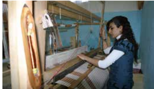
Fotoğraf 4. a. Dokuma tezgâhı üzerinde gücü çerçeveleri ve taraktan geçirilmiş çözgüler b. Çözgülerin tezgâh üzerinde yerleştirilmesi ve dokuma başlangıcının yapılması
