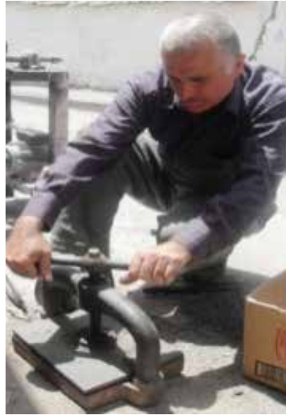
Fotoğraf 5. Presleme, Tesviyeleme ve Diş Açma İşlemi (Emine Tonus,2008)
