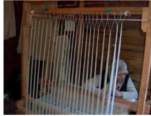
Fotoğraf 1. Ehram dokuma tezgâhı ve dokuma ustası Sevim Ataner (Başaran, 2006), tezgâhın yandan görünüşü ve “V” biçiminde çatal ip (Emir, 2005:79)
