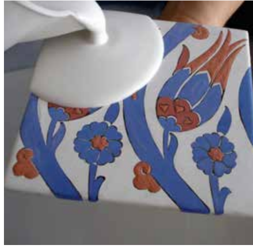
Fotoğraf 3. Renklendirme (URL 5) Akıtma yöntemi ile sırlama (URL 6)
