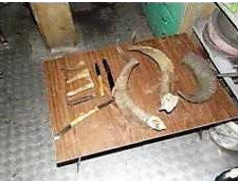
Fotoğraf 2. Hayvan boynuzlarından imal edilen kemik sap üretim aşamaları (Birinci ve Camcı, 2016: 501)
