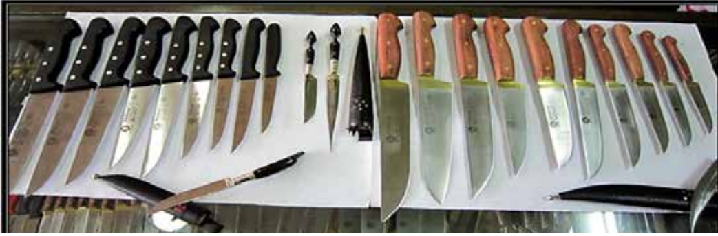
Fotoğraf 3. Ahşap ve fiber bıçak sapı örnekleri (Doğanay ve Çavuş, 2013: 62)
