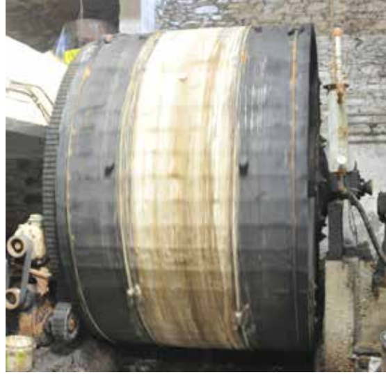
Fotoğraf 3. Derilerin kireçleme ve pişirme işlemi yapıldığı dolap
