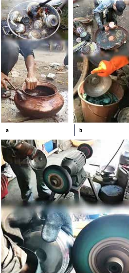
Fotoğraf 5. a. Isıtarak Temizleme (Üst) ve Sürerek Temizleme (Alt) (URL 16., URL 17). b. Kostik'e Yatırma(Üst) ve Kostik'e Daldırma (Alt) (URL 11., URL 18). c. Cila Motoru İle Fırçalama(Üst) ve Cila Motoru Parlatma (Alt) (URL 11).
