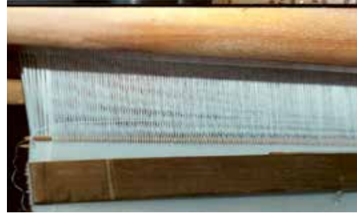
Fotoğraf 4. Dokumanın Üstünde ve Altında İlme Oluşturmak Üzere Geçirilen İlme Mili
