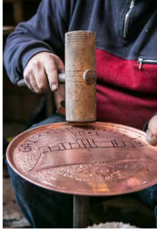
Fotoğraf 2. Tokmakla düzeltme (Gaziantep Bakırcılar çarşısı)
