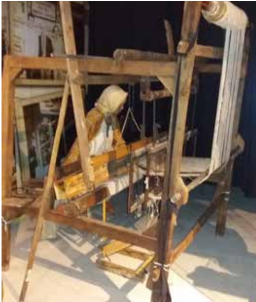
Fotoğraf 1. a. - b. Merinos Müzesi Kamçılı Ahşap İpek Dokuma Tezgâhı, Umurbey İpek Üretim Ve Tasarım Merkezinde Kullanılan Kamçılı Tezgâh (Güneş Yarmacı, 2018).
