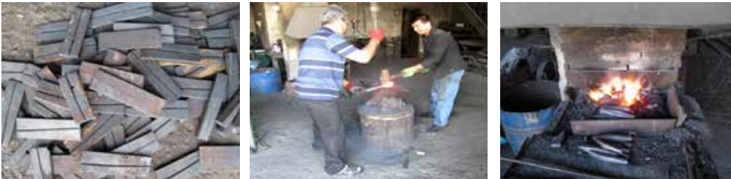
Fotoğraf 4. Parçalanmış kalıplar, Dövme işlemi, Demir parçaların ısıtılması
