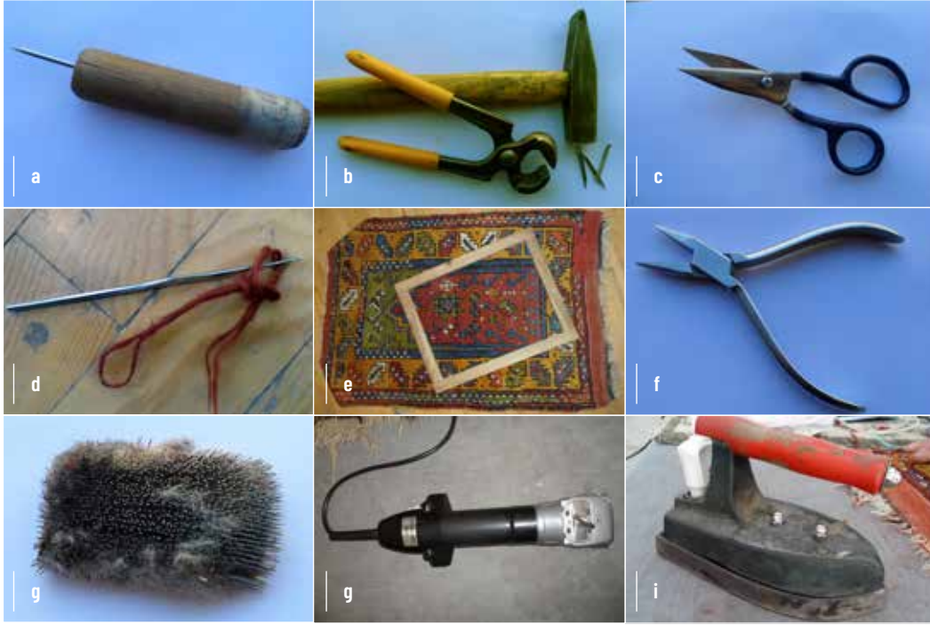
Fotoğraf 1. Halı Tamirinde Kullanılan Araç ve Gereçler (Ünaldi, 2013)
