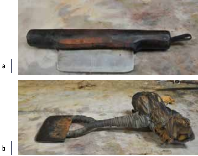
Fotoğraf 5. a. Derileri açmada kullanılan demir silindir aleti b. derileri ütülmede kullanılan alet “voltuk”
