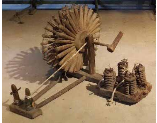
Fotoğraf 2. a. - b. - c. İpek dokuma tezgahı (kamçılı), masura ve çıkırık (Koyuncu, 2011; Karakelle, 2020)
