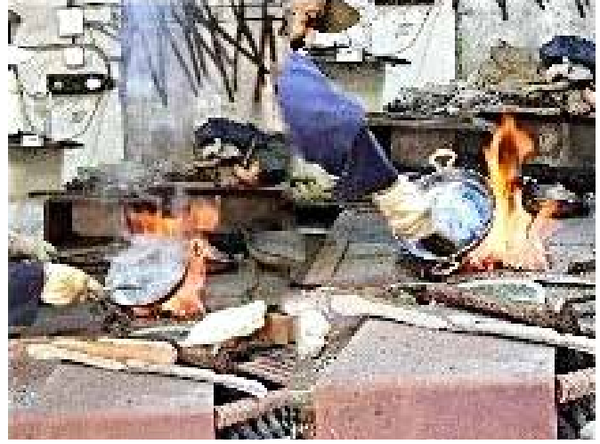
Fotoğraf 6. a. Ocağı Yakma (Sol) ve Ürünü Tavlama (Sağ Üst) ile Üründen Çıkan Nişadır Dumanı (Sağ Alt);, b. Çubuk Kalay ile Kalayı Sürme (Sol) ve Kalay Almayan Yerlerin Fırçalanması (Sağ).
